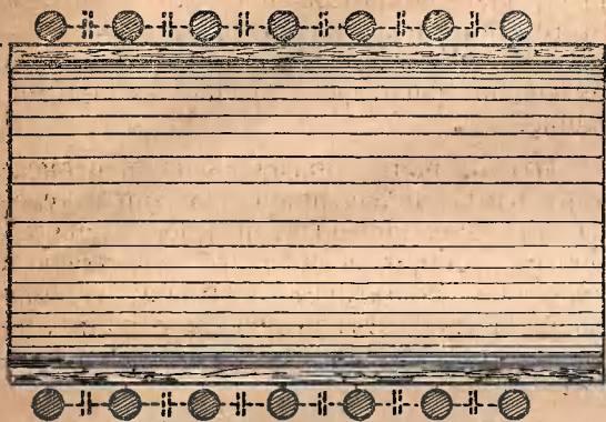
Рис. 1. Показывает происхождение емкости катушек за счет емкости между соседними витками.
